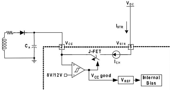
**Figure 14. Startup Circuit**
