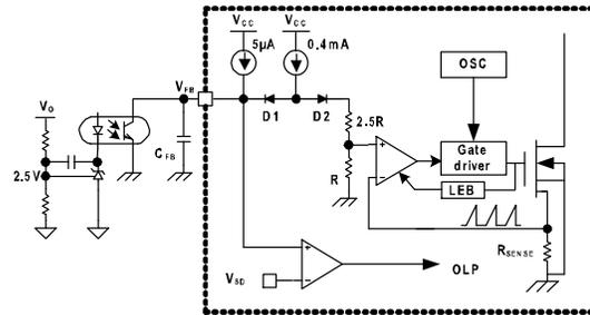
**Figure 16. Pulse-Width-Modulation Circuit**
